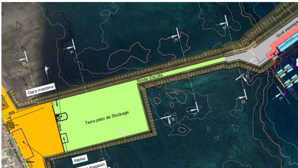
Figure 30: Vue en plan digue d'accès
