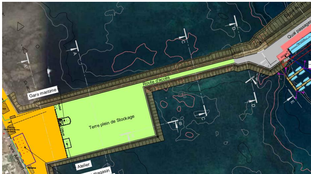
Figure 39: Vue en plan digue d'accès
